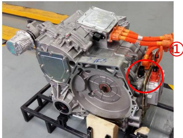
①、检查发电机旋变接插件是否接插良好。（图①）注意检查该接插件的线束是否断裂或者端子退针。
