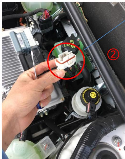
②、检查电机控制器ISG通讯插头（白色）的接插是否正常（图②），注意检查该接插件的线束是否断裂或者端子退针。
